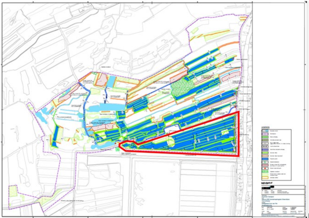
Overzichtskaart uitgevoerde en ingeplande werkzaamheden zuidoostelijk deel deelgebied Kooi van Pen Rode lijn: bomen zijn reeds verwijderd in winter '23 – '24 en start graven trekgraten najaar '24. Paarse stippellijn: totaaloverzicht uit te voeren werkzaamheden zuidoostelijk deel deelgebied Kooi van Pen
